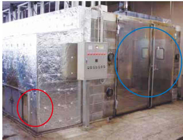
Yaizu-style dryer (medium-scale baikan system)
