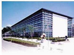
「光」…大きな窓から自然採光を徹底して利用し、照明エネルギーを低減。
