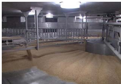
● 円型製麴室内（キッコーマン食品製造第1部）
