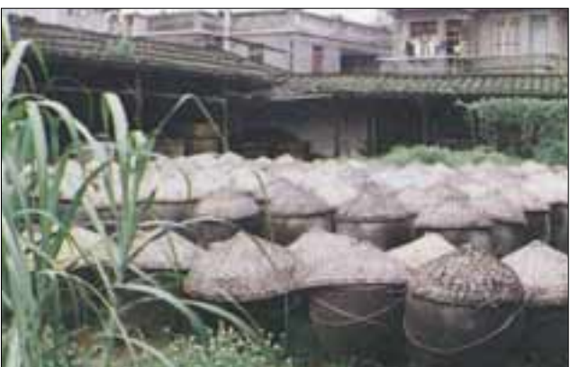
中国の醤油工場。独特のカメに入れて8か月ほど寝かせてつくる。
