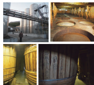
巨大な屋外発酵タンク(写真左上)を抜けた敷地奥に、30石の木桶約200本を有する醸造蔵3棟(2号棟・写真右上)を残している。表板に明治38年と記された木桶(写真右下)は、114年間も使われてきたことになる。真竹の箍(たが)が緩んできたものは金属ベルトで補修して(写真左下)、杉板の状態がよければあと50年のもつという。(株)島醸にて撮影。
