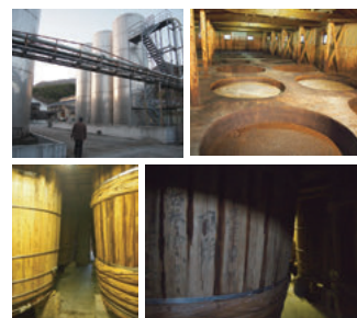
巨大な屋外発酵タンク(写真左上)を上げた敷地奥に、30石の木桶約200本を有する醸造蔵3棟(2号棟・写真右上)を残している。表板に明治38年と記された木桶(写真右下)は、114年間も使われてきたこととなる。真竹の籠(たが)が緩んできたものは金属ベルトで補修して(写真左下)、杉板の状態がよければあと50年はずつという。(株)島醸にて撮影。
