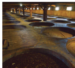
30石(5400L)の木桶112本が4列に整然と並べられた天然醸造蔵。観光客が外から見学できるように、ガラス張りにして虫や鳥が入らない様に管理されている。既に木桶の推定年は100年を超える。木桶の間隔が狭く、組み直しも補修作業も難しい。使えなくなった木桶は上板をはめ、その数は少しずつではあるが年々増えていく。マルキン醤油(株)にて撮影。
