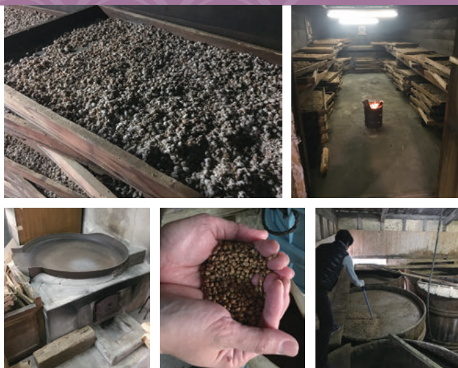
薪炊きで温度調節をする麹室(右上)。麴蓋で製麹4日目のしょうゆ麹(左上)。小麦を煎る窯も薪炊きで行う(左下)。こんがりと煎り上がった小麦(中下)。木桶に渡した板は先代から譲り受けた位置のままだという。その板の上から糶入れを行う(右下)。堀河屋野村にて撮影。
