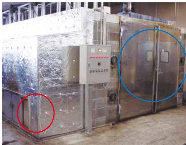
焼津式乾燥機(中規模の焙乾装置)
